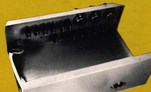
Afb. 2 De binnenzijde van de kast geeft een mooie aanblik als alle schakelaars, potmeters en LED's zijn gemonteerd.
