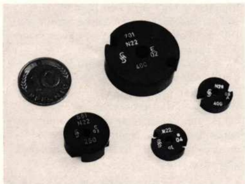
Afb. 4 Op de kernhelften is de A_L -waarde en het type materiaal gestempeld.
