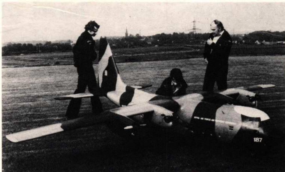
Afb. 9 Het grootste deel van dit model is uit piep-schuim vervaardigd.
