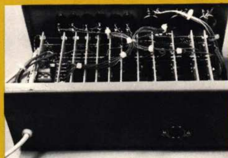
Afb. 7 Voor doorvoer van het netsnoer is een elegante tule gebruikt: een voorstuk van een bananeplug (chassisdeel).
