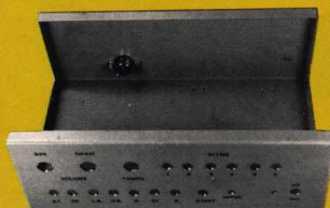
Afb. 1 Het onderstuk van de kast, voorzien van de nodige gaten en tekst.
